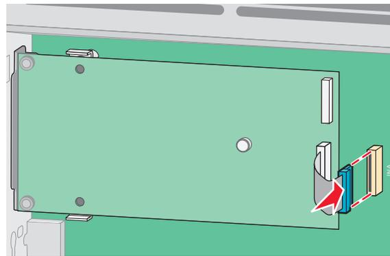
**12** 프린터 하드 디스크를 이전에 설치했을 경우에는 프린터 하드 디스크를 ISP에 부착합니다. 자세한 내용은 30 페이지의 “프린터 하드 디스크 설치”을(를) 참조하십시오.
