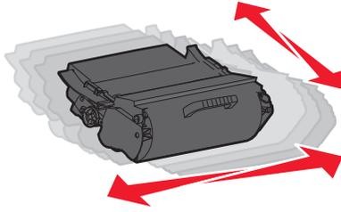
5 토너 카트리지의 롤러를 PC 장치 키트의 트랙에 있는 화살표와 맞추고 새 토너 카트리지를 설치합니다. 토너 카트리지를 끝까지 밀어 넣습니다. 카트리지가 제대로 설치되면 찰칵하는 소리가 납니다.
