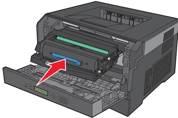
7 PC 장치 키트를 교체한 후 PC 장치 카운터를 재설정합니다. 카운터를 재설정하려면 새 PC 장치 키트와 함께 제공된 지침 안내서를 참조하십시오.
