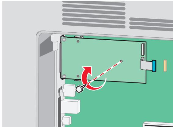
**9** 제공된 나사 2개를 부착하여 ISP 장착 브래킷을 시스템 보드 케이스에 고정시킵니다.
